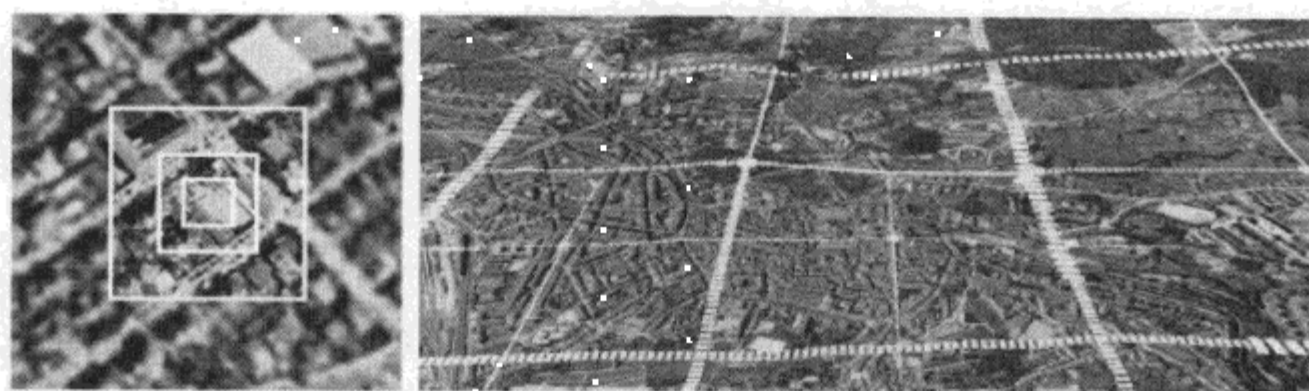
图 5.8.4 细节环和一个应用于地形的虚拟纹理的例子,利用颜色代码来显示细节层次
